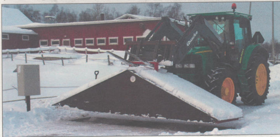
För att vågen ska fungera kländerfritt även på vintern bör man se till att hålla den snöfri. Brunell har gjort ett smidigt tak som är enkelt att ta bort.
