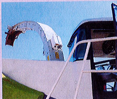
Scanner montato su mietitrebbia Claas.
