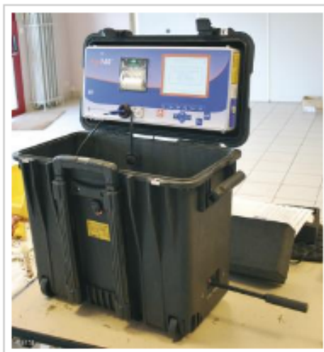
AgriNIRT®, le laboratoire portable, utilise la technologie infrarouge pour analyser les fourrages en instantané sur l'élevage. - © terra
